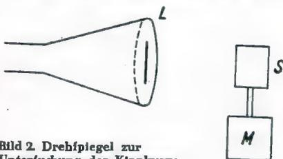
Bild 2. Drehspiegel zur Untersuchung der Kippkurve.
